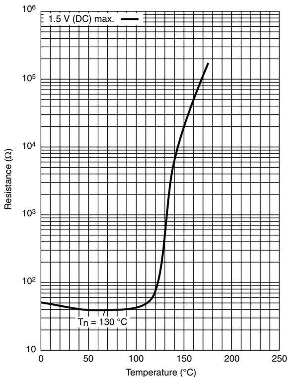
**TYPICAL RESISTANCE/TEMPERATURE CHARACTERISTIC FOR 2381 671 91112 and 91114**
