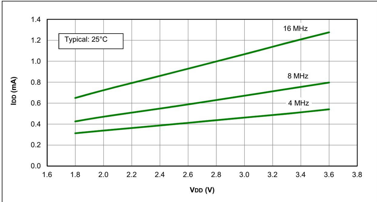
FIGURE 26-24: I<sub>DD</sub> MAXIMUM, HFINTOSC MODE, PIC16LF1516/7/8/9 ONLY
