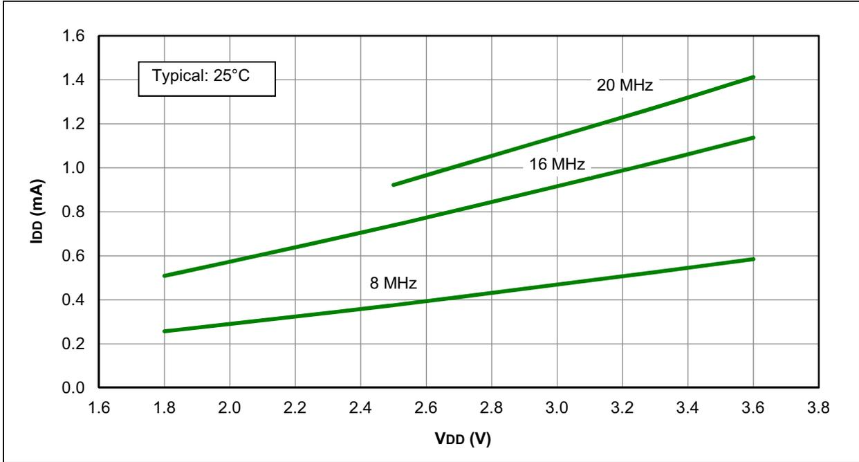
FIGURE 26-16: I<sub>DD</sub> MAXIMUM, EC OSCILLATOR, HIGH-POWER MODE, PIC16LF1516/7/8/9 ONLY
