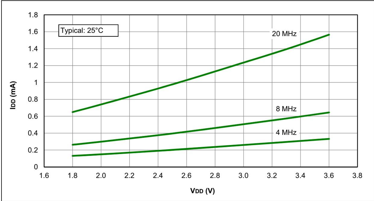
FIGURE 26-28: I<sub>DD</sub> MAXIMUM, HS OSCILLATOR, PIC16LF1516/7/8/9 ONLY
