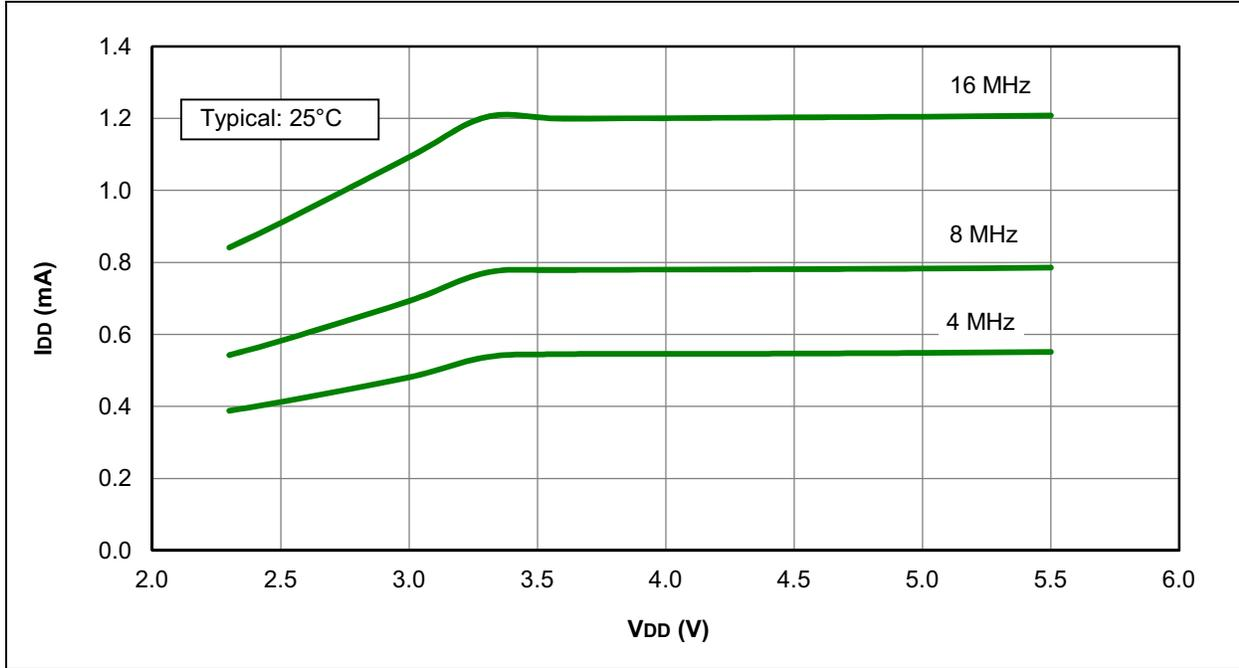
FIGURE 26-26: I<sub>DD</sub> MAXIMUM, HFINTOSC MODE, PIC16F1516/7/8/9 ONLY
