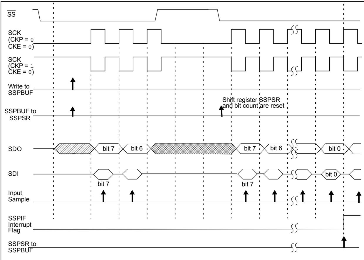
**FIGURE 21-9: SPI MODE WAVEFORM (SLAVE MODE WITH CKE = 0)**
