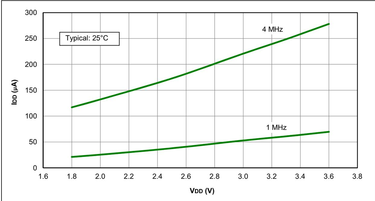
FIGURE 26-12: I<sub>DD</sub> MAXIMUM, EC OSCILLATOR, MEDIUM-POWER MODE, PIC16LF1516/7/8/9 ONLY
