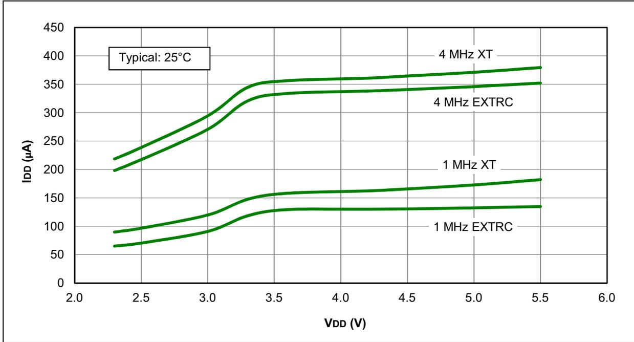
FIGURE 26-6: I<sub>DD</sub> MAXIMUM, XT AND EXTRC OSCILLATOR, PIC16F1516/7/8/9 ONLY
