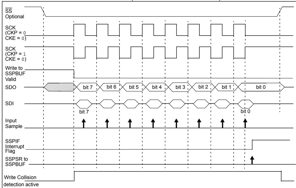
**FIGURE 21-10: SPI MODE WAVEFORM (SLAVE MODE WITH CKE = 1)**
