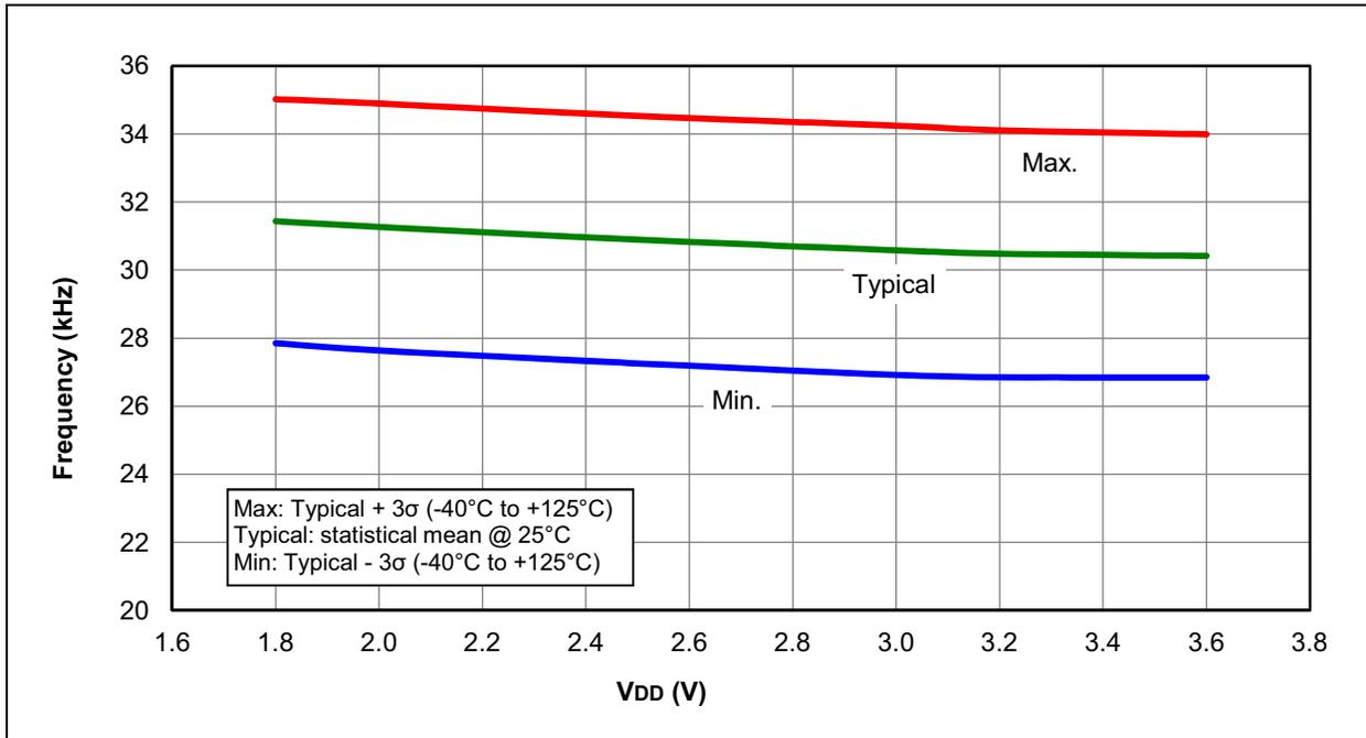
**FIGURE 26-61: LFINTOSC FREQUENCY OVER V<sub>DD</sub> AND TEMPERATURE, PIC16F1516/7/8/9 ONLY**
