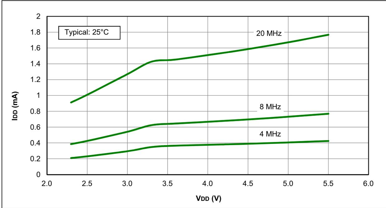
FIGURE 26-30: I<sub>DD</sub> MAXIMUM, HS OSCILLATOR, PIC16F1516/7/8/9 ONLY
