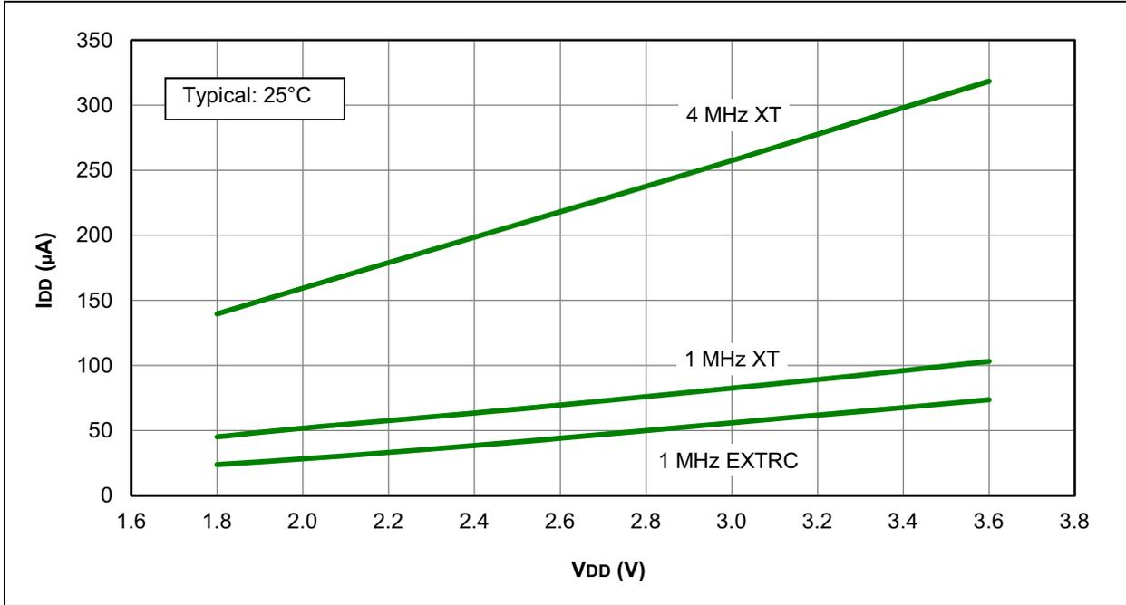
**FIGURE 26-4: I<sub>DD</sub> MAXIMUM, XT AND EXTRC OSCILLATOR, PIC16LF1516/7/8/9 ONLY**
