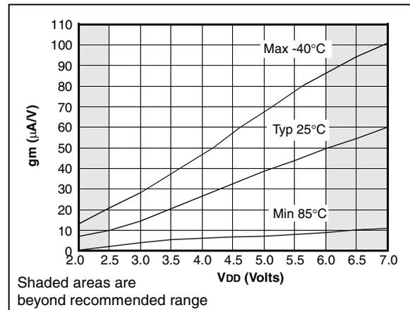
**FIGURE 14-21: TRANSCONDUCTANCE(g<sub>m</sub>) OF XT OSCILLATOR vs. V<sub>DD</sub>**
