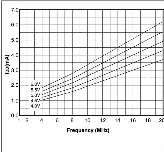
**FIGURE 14-30: MAXIMUM I<sub>DD</sub> vs. FREQUENCY
