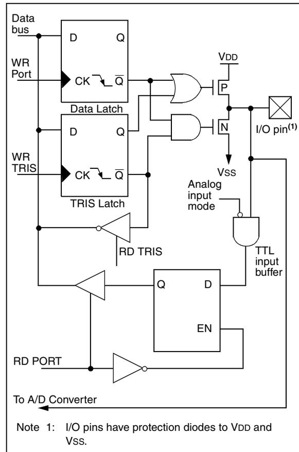
**FIGURE 3-2: BLOCK DIAGRAM OF RA4/T0CKI PIN**
