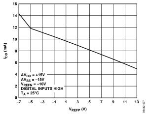
Figure 15. I<sub>DD</sub> vs. V<sub>REFP</sub>
