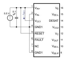
Figure 28. I<sub>CC1H</sub> Test Circuit
