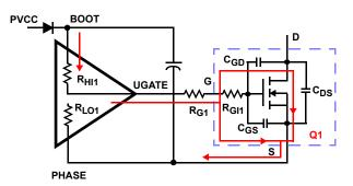
FIGURE 19. TYPICAL UPPER-GATE DRIVE TURN-ON PATH
