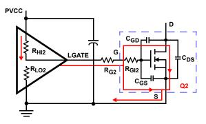
FIGURE 20. TYPICAL LOWER-GATE DRIVE TURN-ON PATH
