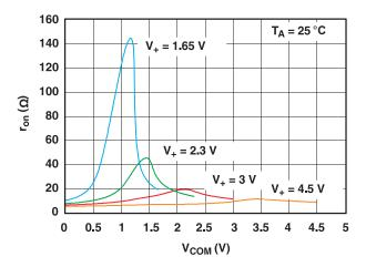
Figure 23. ron vs V<sub>COM</sub>
