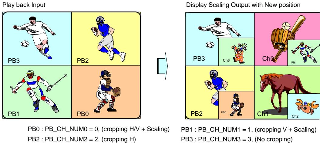
FIGURE 14 THE EFFECT OF SCALING FUNCTION IN PLAYBACK
