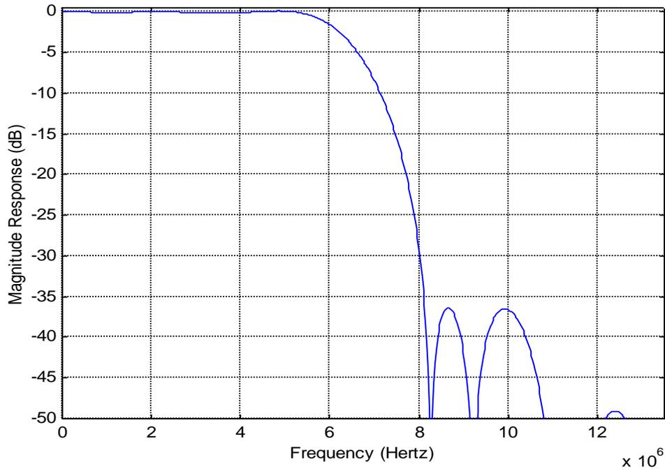
FIGURE 3 THE CHARACTERISTIC OF THE DECIMATION FILTER
