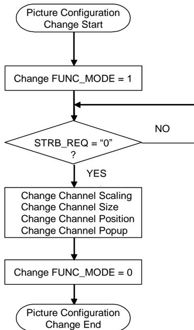
FIGURE 20 THE SEQUENCE TO CHANGE PICTURE CONFIGURATION
