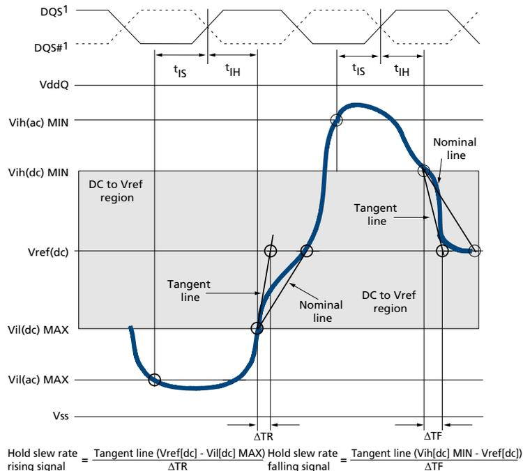
Note: 1. DQS, DQS# signals must be monotonic between  $V_{il}(DC) \text{ MAX}$  and  $V_{ih}(DC) \text{ MIN}$ .
