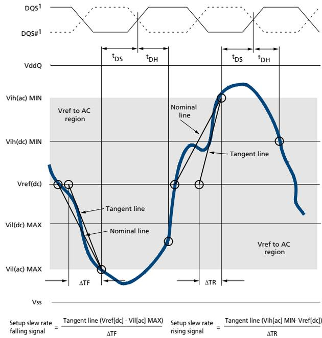
Note: 1. DQS, DQS# signals must be monotonic between  $V_{il}(DC) \text{ MAX}$  and  $V_{ih}(DC) \text{ MIN}$ .
