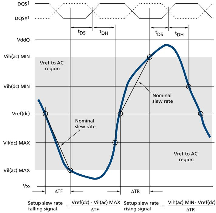
Note: 1. DQS, DQS# signals must be monotonic between  $V_{il}(DC) \text{ MAX}$  and  $V_{ih}(DC) \text{ MIN}$ .
