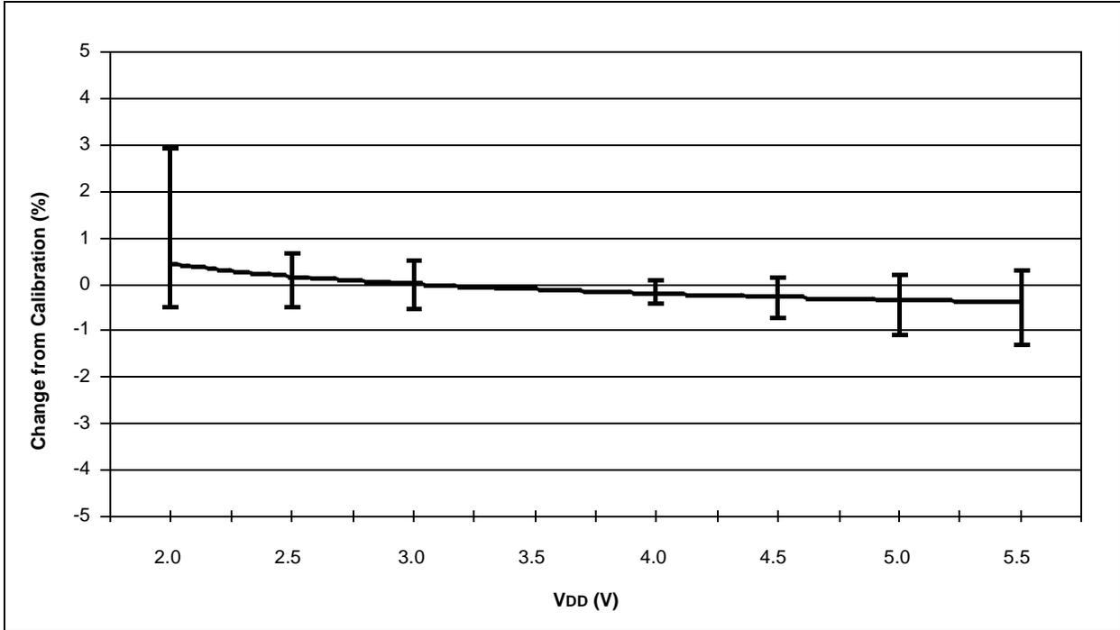
FIGURE 16-37: TYPICAL HFINTOSC FREQUENCY CHANGE OVER DEVICE V<sub>DD</sub> (85°C)
