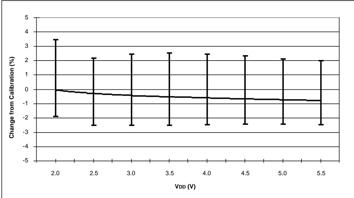
FIGURE 16-39: TYPICAL HFINTOSC FREQUENCY CHANGE vs. V<sub>DD</sub> (-40°C)
