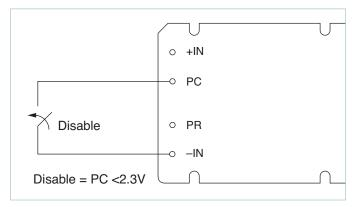
Figure 2 — Module enable/disable
