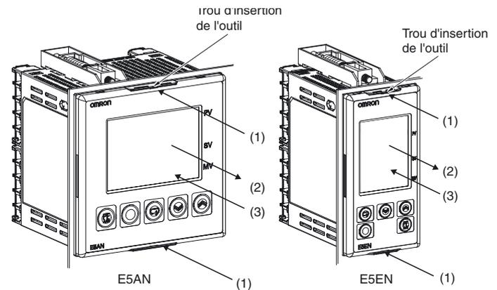
1. Insérez un tournevis plat dans les deux trous (un en haut et l'autre en bas) pour relâcher les crochets.
