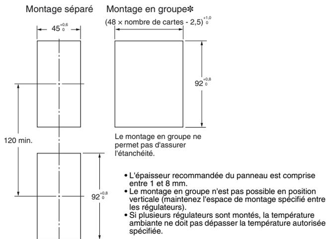
\* Le montage en groupe n'est pas possible lorsque la sortie relais sert de sortie de contrôle 1 ou 2 et que la carte de sortie E53-C3N ou E53-C3DN est utilisée. Pour ces combinaisons, maintenez l'espace de montage suivant entre les régulateurs.
