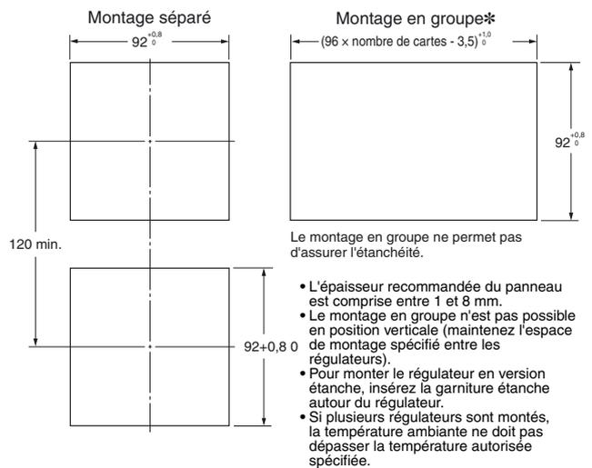
\* Le montage en groupe n'est pas possible lorsque la sortie relais sert de sortie de contrôle 1 ou 2 et que la carte de sortie E53-C3N ou E53-C3DN est utilisée. Pour ces combinaisons, maintenez l'espace de montage suivant entre les régulateurs.
