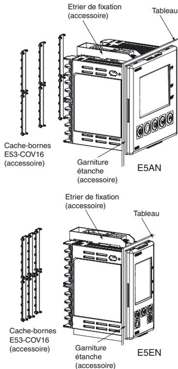
1. Insérez le E5AN/E5EN dans le trou de montage carré du panneau (épaisseur : 1 à 8 mm). Fixez les supports de montage fournis avec le produit aux rainures situées sur le haut et le bas du boîtier arrière.
