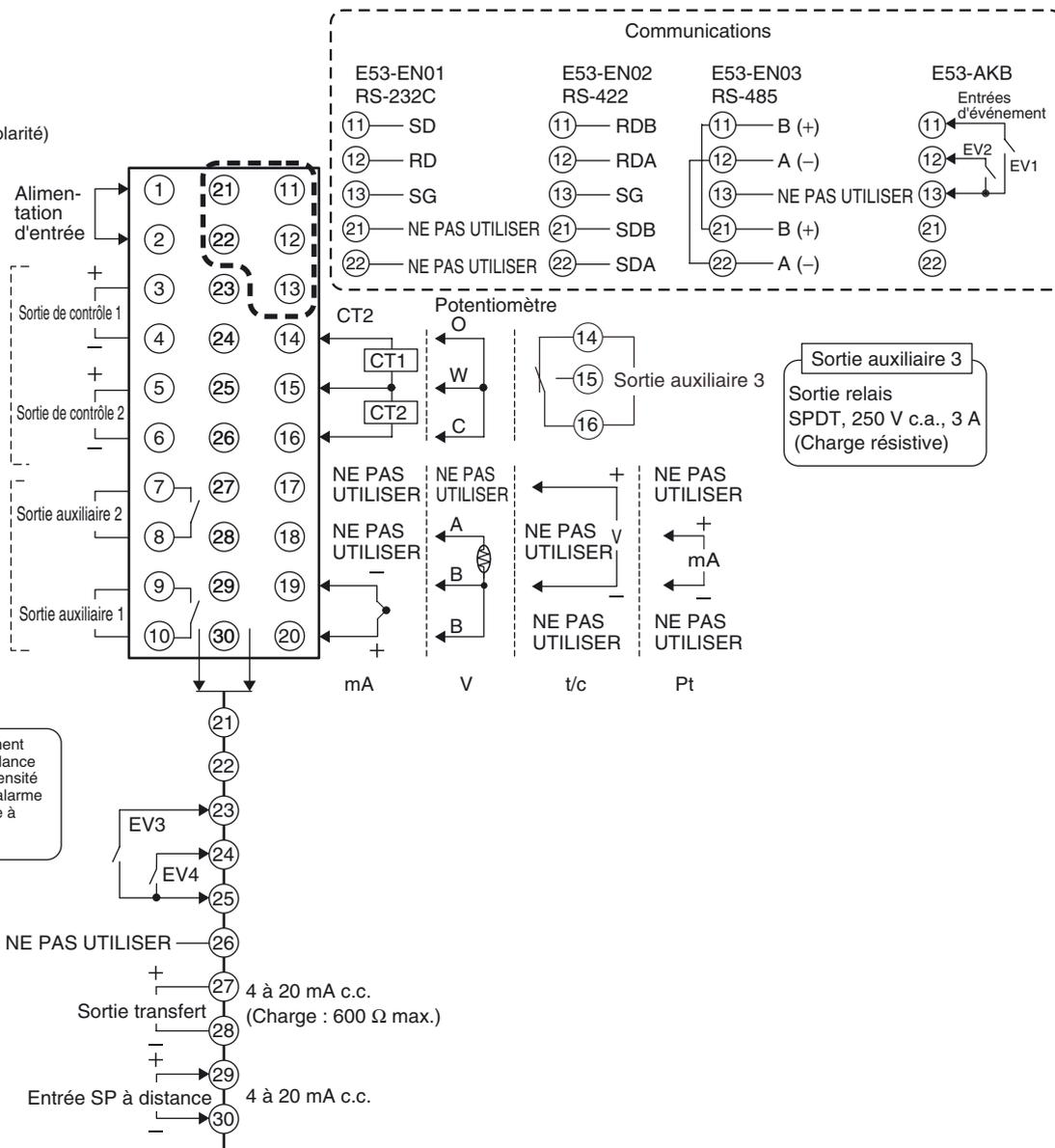
**Remarque :** Câblez correctement toutes les bornes de l'entrée de tension. Le câblage incorrect des bornes de l'entrée de tension peut provoquer le dysfonctionnement du régulateur.
