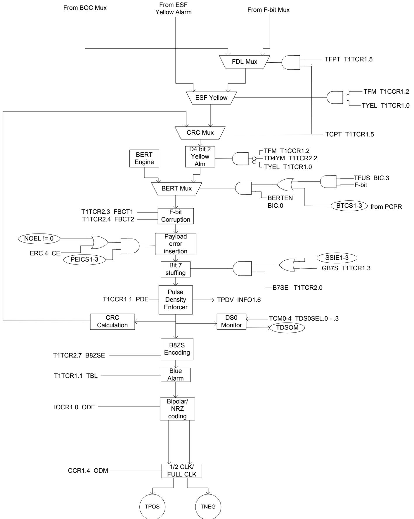
**Figure 33-2. E1 Transmit Flow Diagram**
