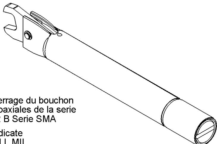
Cette clé est destinée au serrage du bouchon du connecteur des fiches coaxiales de la série RADIALL MIL - C -39012 B Serie SMA
