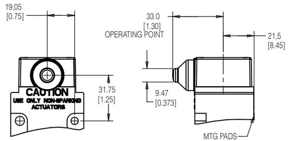
Figure 11. MICRO SWITCH™ LSX SERIES SIDE ROLLER PLUNGER, HEAD CODE F • mm [in]
