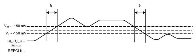
Figure 4. HCSL Rise Fall Time and Edge Speed
